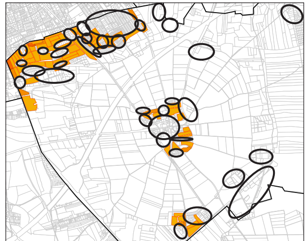
Abb. 4.5: Wärmebedarfsdichte Hohenbrunn, 20-Jahre-Zukunftsszenario, 50 % Abnahmequote, entspricht Ausschluss von Gebieten mit einer Wärmebedarfsdichte von weniger als 300 MWh/(ha·a)
